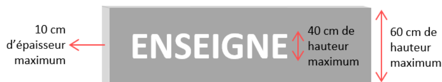
Figure 11 : Illustration indicative et non opposable des règles de gabarit des enseignes parallèles sur bâtiment ne présentant pas d'intérêt patrimonial
