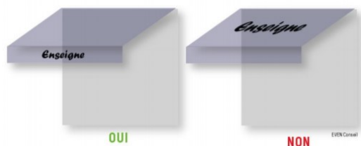
Figure 10 : Illustration indicative et non opposable des règles d'implantation des enseignes sur store
