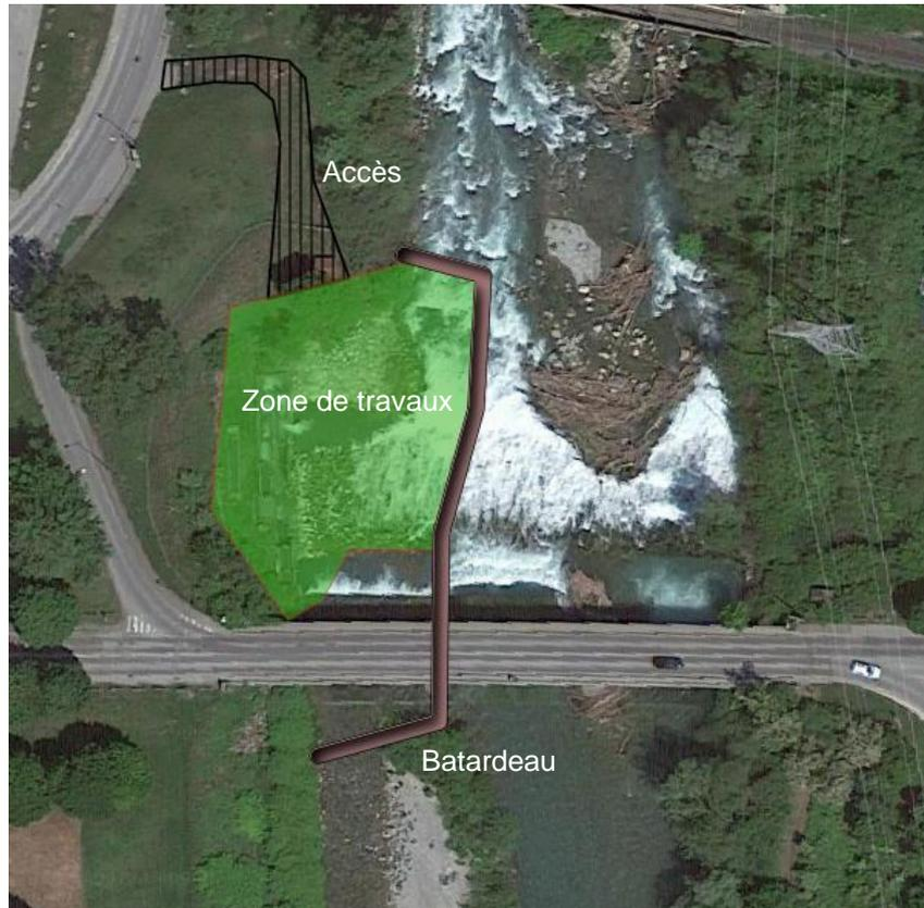
Figure 9 : Localisation des travaux de la phase 2
