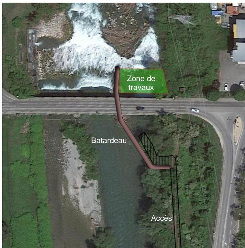
Figure 11 : Localisation des travaux de la phase 4
